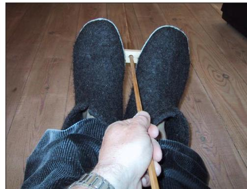
1. Entfernen Sie das Gummiband auf der einen Seite des Hilfswerkzeuges und zwingen dort die beiden Hälften so weit auseinander, dass Sie das Hilfswerkzeug unter der Verhülsung über den Handteil der Rute im Loch des Hilfswerkzeuges plazieren können. Befestigen Sie das Gummiband wieder dort, wo Sie es vorher entfernt haben.
