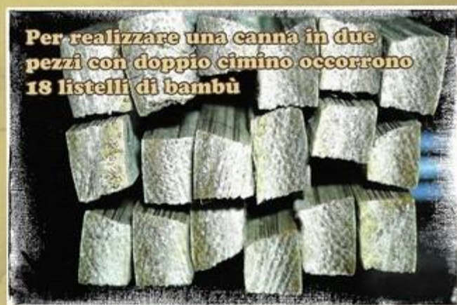
I 18 listelli di una canna in due pezzi con doppio cimino prima della piallatura
