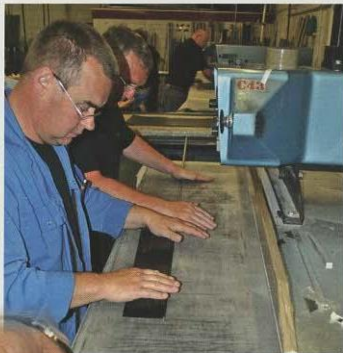
Hardy-Mitarbeiter beim Rollen der Kohlefaser-Matten um den Stahlkern
