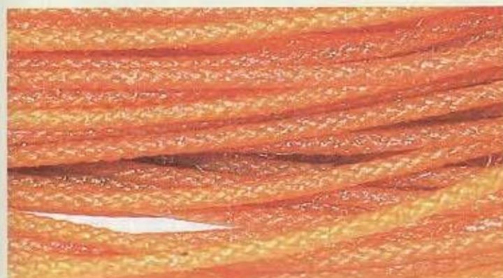
Eine Altschnur, ungereinigt. Die Windungen kleben aneinander. Die Vertiefungen sind nicht gefüllt. Die Schnur muß gereinigt und neu imprägniert werden.
