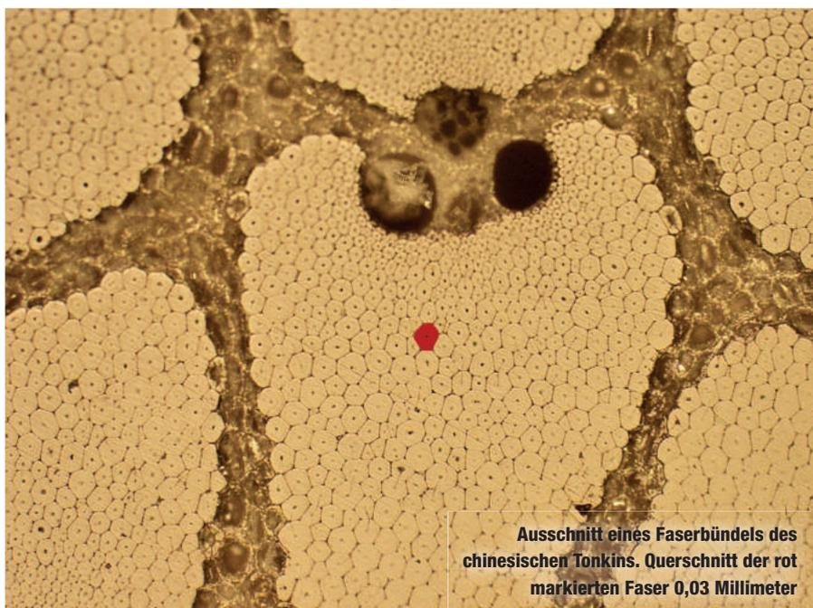
Ausschnitt eines Faserbündels des chinesischen Tonkins. Querschnitt der rot markierten Faser 0,03 Millimeter
