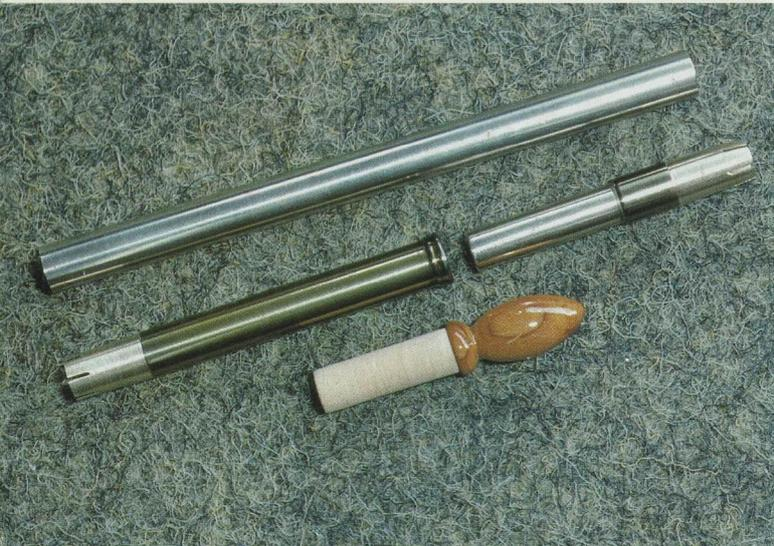
*Die Steckverbindungen (Lamellenhülsen) werden von mir aus Neusilber (Nickellegierung) hergestellt. Die präzise Passung garantiert einen sicheren Sitz zwischen Hand- und Spitzenteil.*
