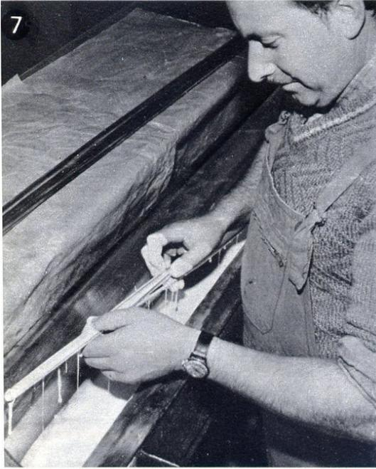
7 - Une fois sélectionnées et sommairement assemblées par deux morceaux de ficelle, les baguettes sont trempées à la main dans un bain de colle à froid.
