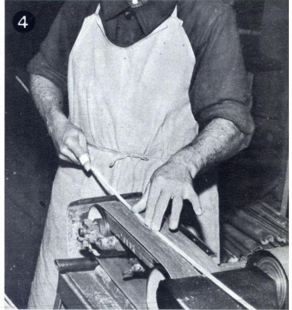
3 - Puis les bambous sont coupés en deux dans le sens de la longueur. Après assemblage en fonction de l'emplacement des nœuds (il faut toujours intercaler les nœuds de l'un des éléments avec les nœuds de l'autre, de façon que deux nœuds ne se retrouvent jamais l'un à côté de l'autre), on débite les demi-bambous en baguettes.
