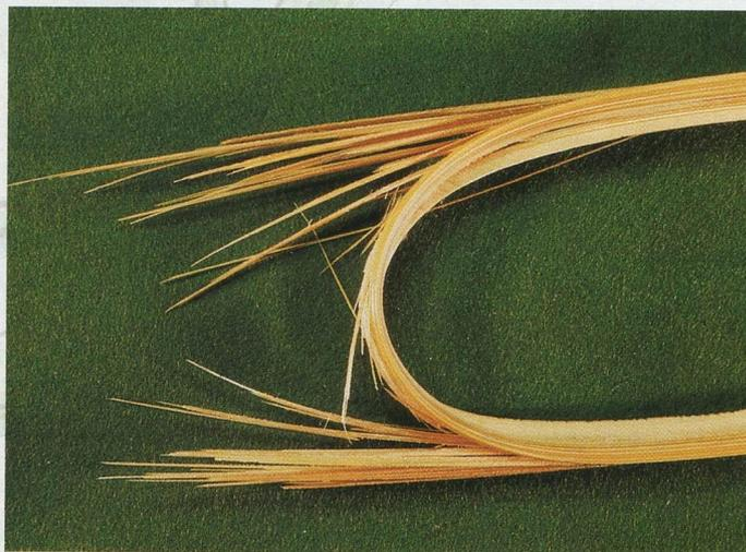
*Power Fibers, die dünnen und extrem zähen Cellulose-Fibern, erkennt man am besten bei einer gebrochenen Rute. Ingo Karwath hat diesen Spleiß gehobelt und dann zerbrochen, um Ihnen diese zu zeigen. Das nennt man unter Handwerkern „Edelschrott“...*
