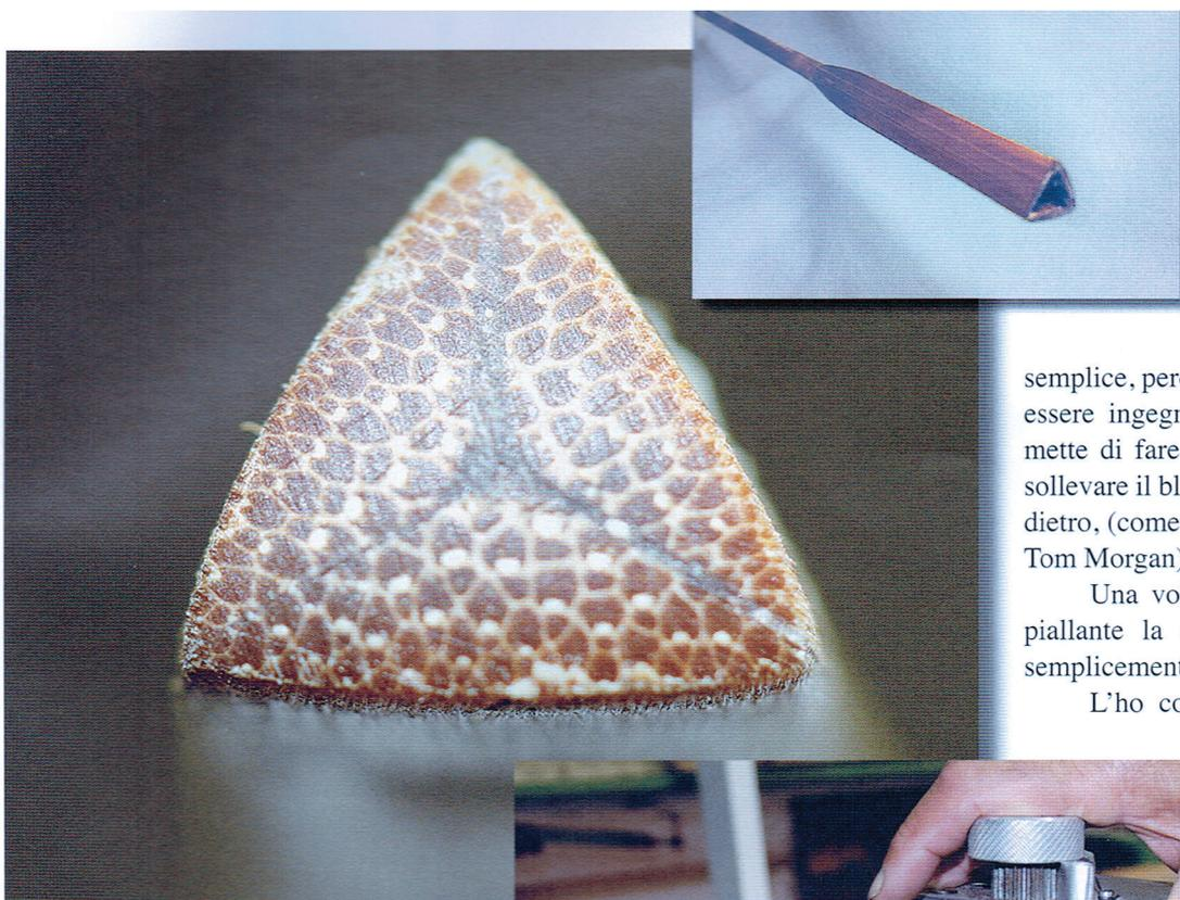
*Foto in alto: sezione di canna triangolare, la più leggera in assoluto, in alto ed in piccolo ecco come l'autore ha risolto il problema dell'innesto.*
