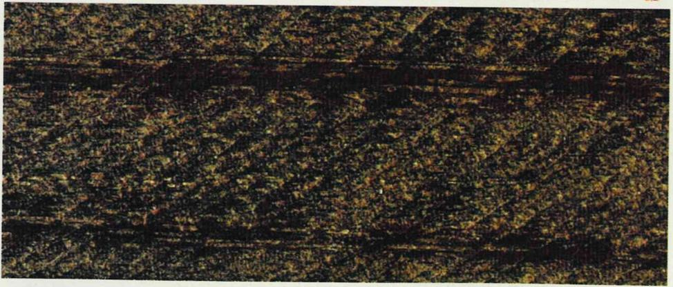
Abb. 3: Mit seiner feinen Faserstruktur ist Greenheart-Holz zum Rutenbau sehr geeignet.
